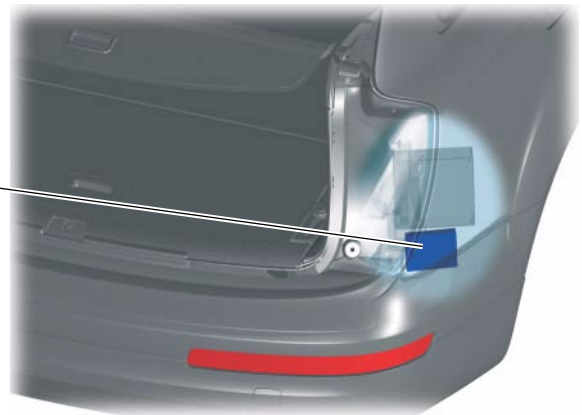
Einbauort der Antenneneinleseeinheit für schlüssellose Zugangsberechtigung J723
